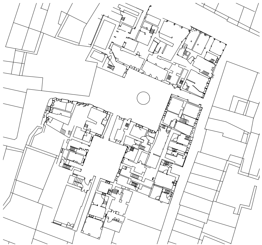
Kaminani Tole の実測図（未完成）。100 年をかけて増築が繰り返され、複雑な形状となっている。（図作成：藤田悠樹）
