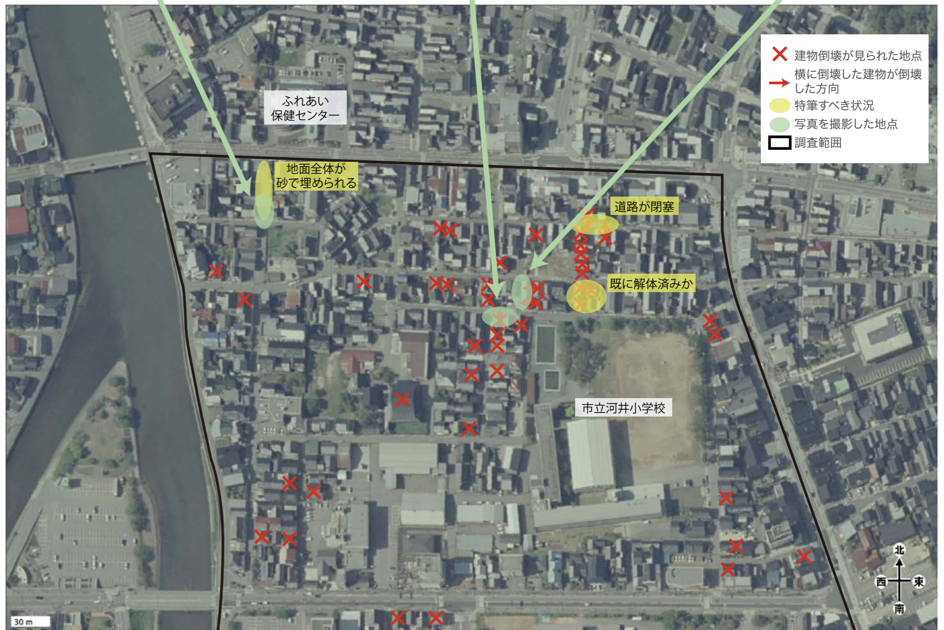
図3-1. 河井町南部の建物倒壊およびその他被害状況
