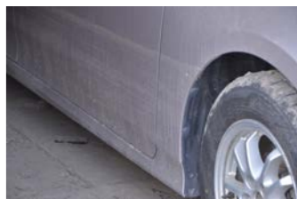
⑧車に残された浸水痕 国道沿いに停めてあった車に高さ50cm程度の浸水痕を確認
